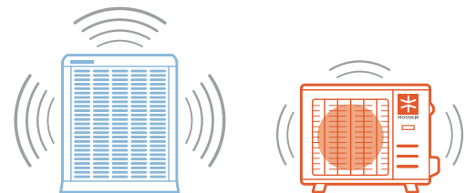
Système central traditionnel: 73 dB(A) Système Central-Moov: 58 dB(A)
