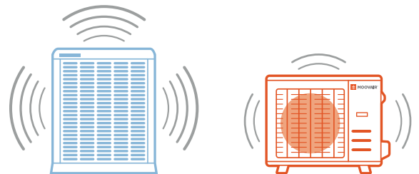
Système central traditionnel : 73 dB(A) Système Central-Moov : 58 dB(A)
